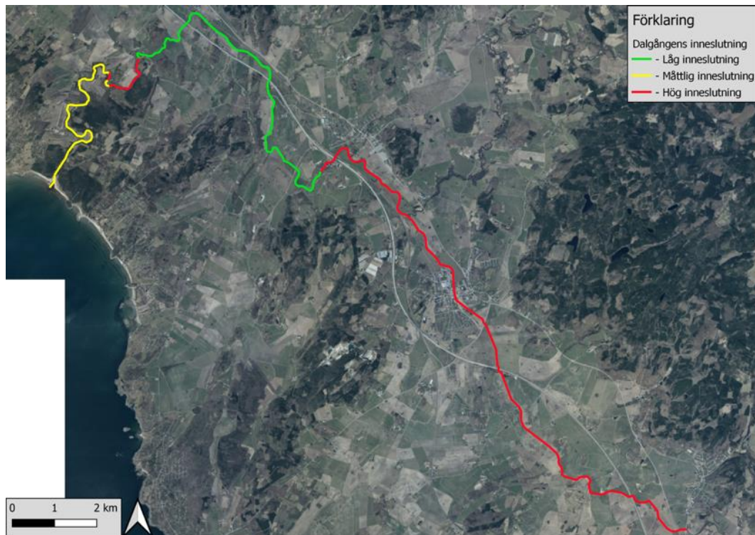
Figur 17. Dalgångens inneslutning vid befintliga förhållanden i Suseån. Notera att det är bedöms som hög inneslutning på områdena uppströms Berte Qvarn trots att dessa översvämmas. Det beror på att omgrävningen har påverkat vattendragsfåran möjlighet att röra sig i sidled så pass mycket att det i stort sett har grävts fram en ny dalgång där vattendraget istället utvecklas över tid, t.ex. där nya sekundära svämplan skapas på en lägre nivå än de stora ursprungliga ytorna som kantar ån.
